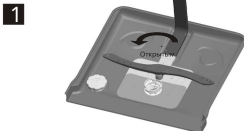
Шаг 1 : Поверните фильтр против часовой стрелки,
