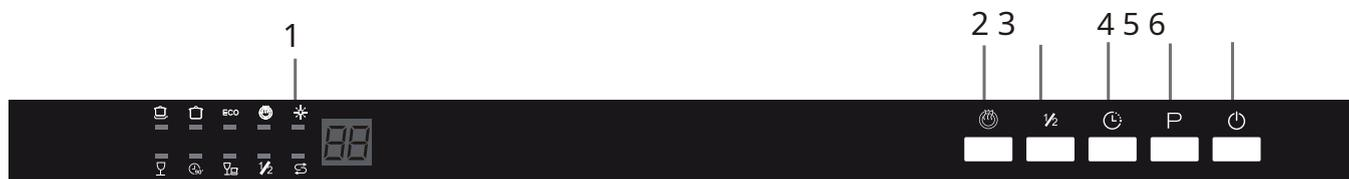
1. Экран дисплея и лампа: для отображения кода ошибки, времени задержки и т. д.
