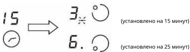
2. По истечении таймера обратного отсчета соответствующая зона выключится. Затем он покажет новый мин. таймер и точка соответствующей зоны будет мигать.
